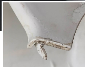
ÎN TIMPUL CURĂȚĂRII: Piesă puternic contaminată scoasă din matriță după aplicarea Lusin® MC1718
